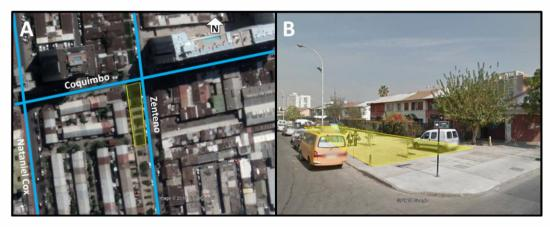
En la figura anterior, se destaca con un rectángulo el área considerada para captar las aguas, que corresponde a un tramo de platabanda, al costado de la vereda. El estanque a instalar quedaría en una esquina del rectángulo de intervención, y se le daría una pendiente al terreno de manera que el agua escurra hasta el punto de captación del estanque enterrado, tal como se muestra en la siguiente figura:
