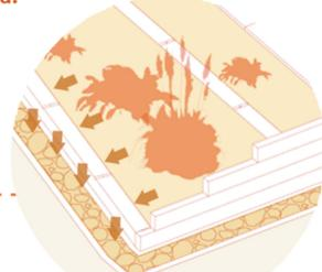
Franja de infiltración que recibirá y redireccionará el agua proveniente de las jardineras.
